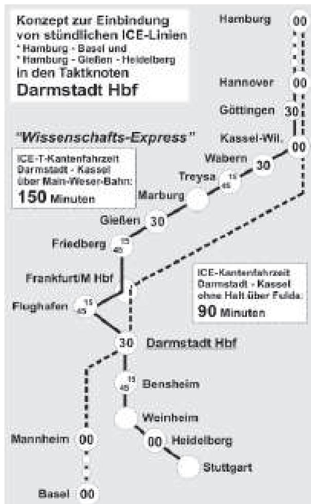
Da der Darmstädter Hauptbahnhof gegenwärtig nur 10 „echte“ Bahnsteigkanten aufweist, wird deutlich: Die gewünschte Knotenfunktion ist ohne Eingriffe in das Gleisbild und den Bau zusätzlicher Bahnsteiganlagen kaum realisierbar.
